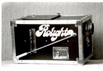
Het zelfgebouwde vloerlevelapparaat
